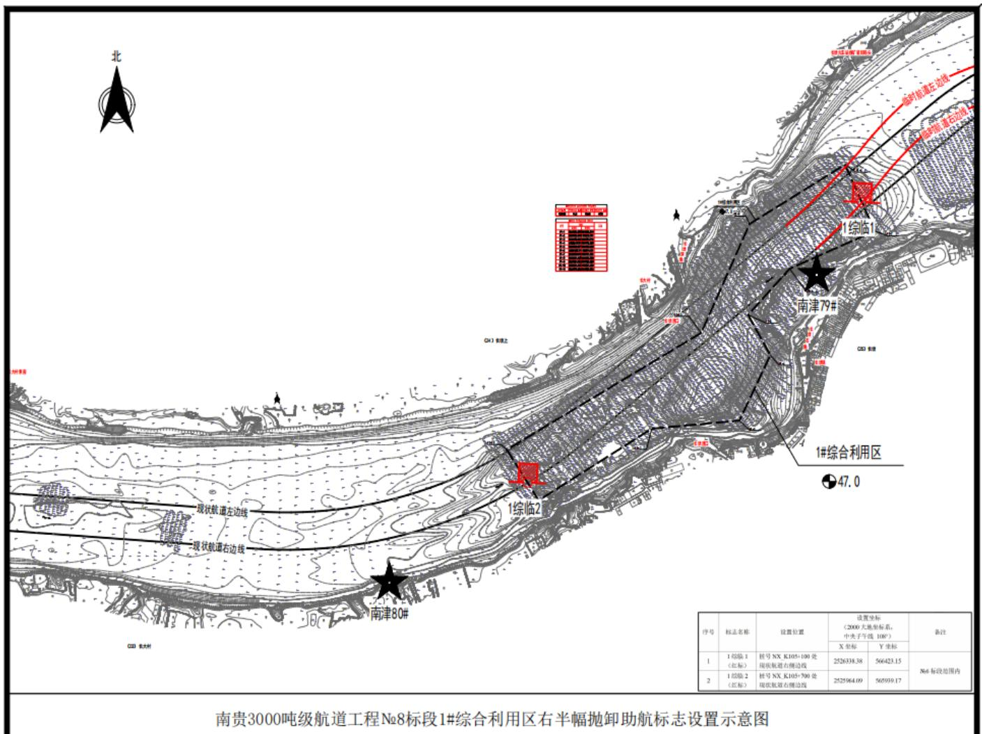
南贵3000吨级航道工程N<sup>o</sup>8标段1#综合利用区右半幅抛卸助航标志设置示意图
